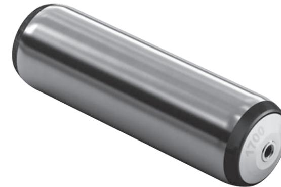
Gli assi con filetto interno consentono, al contrario degli assi ammortizzanti, una struttura molto stabile del telaio e sono sensibilmente meno rumorosi rispetto ai rulli trasportatori montati liberi. Gli assi dei rulli e i profili si stabilizzano reciprocamente, permettendo una maggiore sollecitazione dei rulli trasportatori rispetto alla versione a rulli liberi. Il montaggio e lo smontaggio richiedono più tempo rispetto agli assi ammortizzanti.
