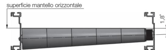
Nella costruzione della curva è indispensabile accertarsi che la superficie di rivestimento degli elementi conici sia orizzontale. Pertanto, l'asse del rullo trasportatore è inclinato di 1,8°.
