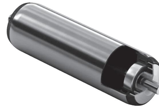
I rulli trasportatori con assi ammortizzanti sono il tipo di asse più semplice e permettono un montaggio e uno smontaggio molto facile e veloce. Per irrigidire il trasportatore è necessario predisporre degli appositi collegamenti trasversali fra i profili del telaio.
